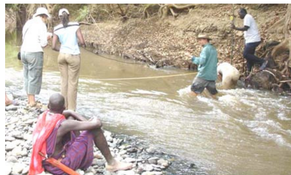
تصویر ۳. اندازه‌گیری سرعت جریان یک رودخانه، انواسو نیگرو، کنیا (عکس: واگنر)
