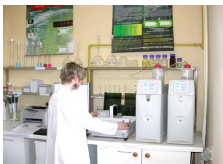
تصویر ۲. کراماتوگراف به منظور آنالیز یون‌ها در نمونه‌های آب (مرکز منطقه‌ای اکوهیدرولوژی اروپا تحت نظارت یونسکو، لودز، لهستان؛ عکس: لزدورسکیک)
